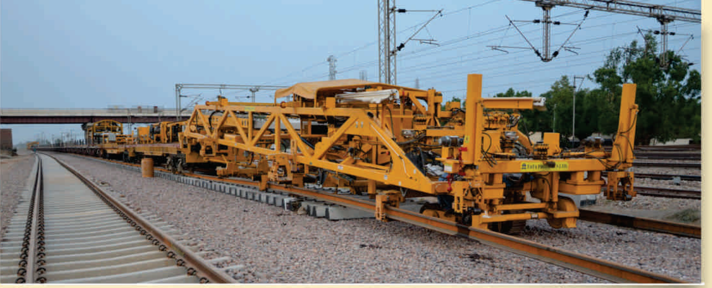
पूर्वी डीएफसी के भाऊपुर-खुर्जा सेक्शन पर एनटीसी मशीन द्वारा ट्रैक बिछाने का कार्य प्रगति पर
